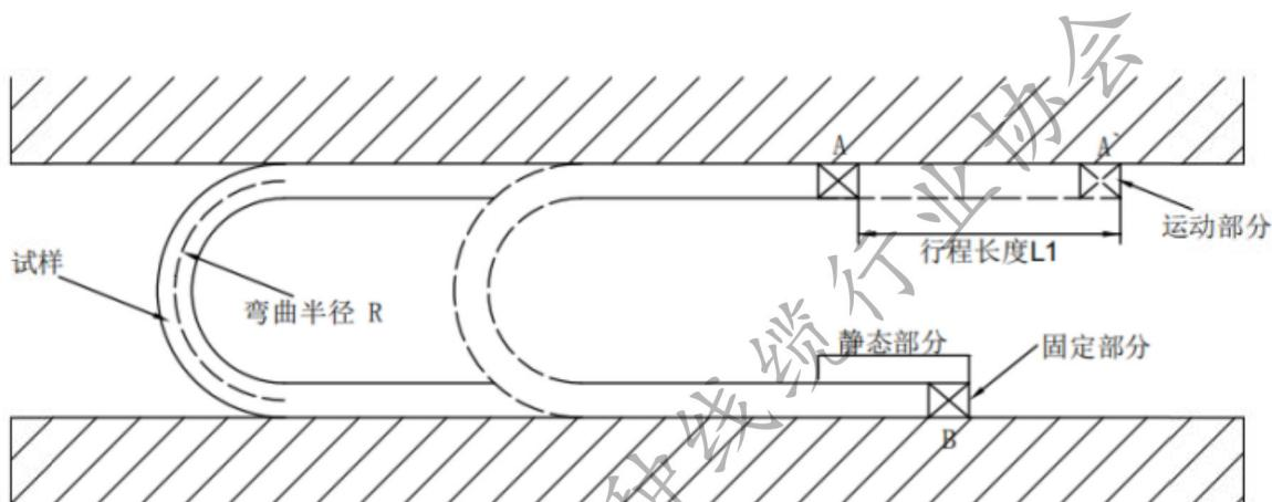
图1 拖链型机器人特种线缆U型拖链试验示意图
